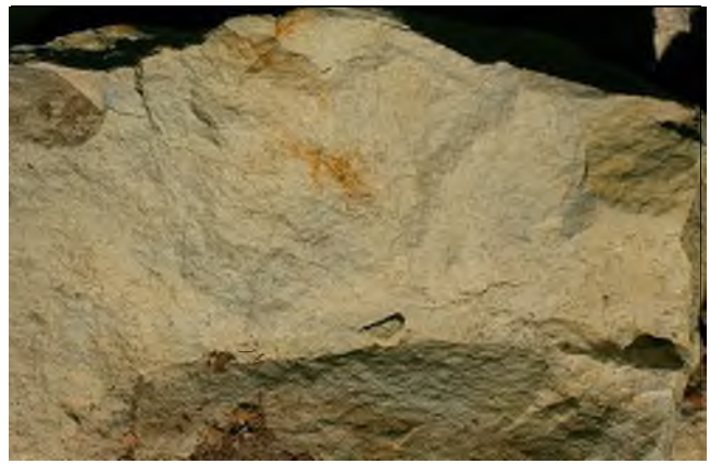
Gaize cénomannienne (= grès argilo-calcaire silicifié par des boues bioclastiques à spicules d'éponge)
