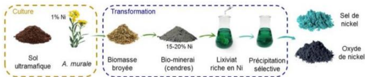
Figure 6. Représentation de la filière agromine , depuis la culture d' Abyssum murale jusqu'à la fabrication de composés commercialisables à base de Ni.
